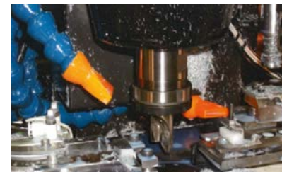
量産部品のバリ取り加工 使用機種: HSM3400
