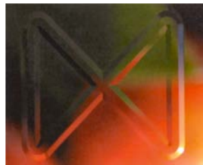
アクリル鏡面加工 ダイヤモンドエンドミル使用 使用機種: HSM3300
