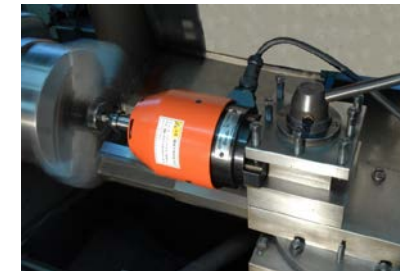
焼入れ部品の内径加工 汎用旋盤の刃物台に装着 使用機種: HSM3300
