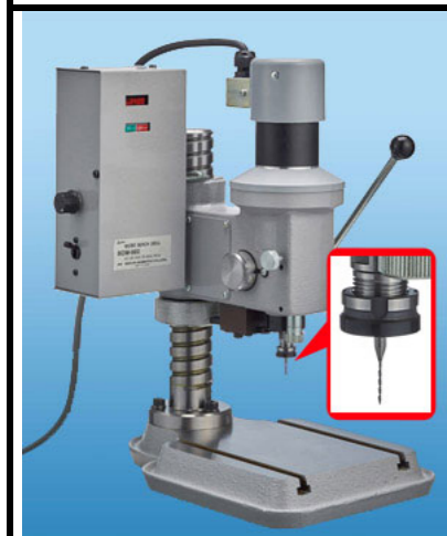
BDM-660 コレットチャック仕様 回転数: 4,500~24,000min -1 (無段 変速)
