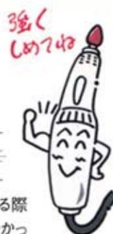
工具をリユーター（グラインダー）に取付ける際に長く出して取付けますと、機械に無理がかかったり、工具が曲がったり、折れたりして危険です。出来るだけ短くしっかりと、取付けてください。
