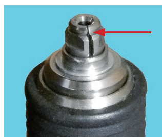
コレットとスリーブコレットの スリットを合わせて下さい。
