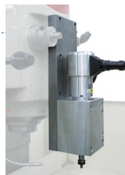
モーターホルダーを使用している フライスへの取付例
