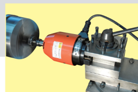
ツールポストアタッチメントを使用しての汎用旋盤での内径研削例
