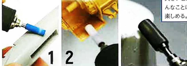
▲最高38,000回転とかなりの高回転まで使用できるが、プラスチックを加工するには、ややオーバースペックの感がある。しかし、低速域での安定感は感動もの。 1. 凸モールドのファスナーを彫り直すために、セラミックゴムの砥石で削り落とす。高精度で安定感があるため、胴体までうっかり削りすぎてしまうことがなく、ピンポイントの切削、磨き作業を行える。 2. 戦車のフェンダーの薄加工を行ってみた。手先の微妙な強弱で削り具合を調整でき、ぶち抜いてしまうのでは？という不安感は全くない。 3. 高回転での性能をチェック。カッターでレジンブロックを削る。面白いほどサクサクとレジンが削れていく。レジンキットやフルスクラッチにはバッチャリなパワー。付属のスリーブコレットを装着して234mm径の先端工具も使用可能だ。
