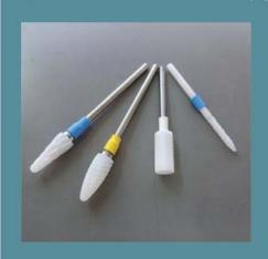
ジルコニアを材質にした研削工具です。 樹脂などの研削に向き、軽量のため芯ブレが少 なく、切削時の発熱が少ないので、発熱による材 料・刃部に与える影響が少ない特徴があります。
