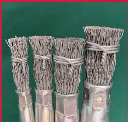
φ0.3mmの硬鋼線を亜鉛メッキした毛材を使用。研削力があり折損率が低く、高耐久性のブラシです。ブラシを結束し、先端が確実にワークを捉えますのでバリ取り、鏽取り、溶接のビート除去に最適です。
